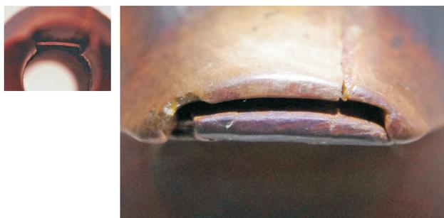
**ABBILDUNG 16** Die Altblockflöte von Terton. Das linke Bild von 1981 ist nach Entfernung des Blocks auf die Labiumkante fokussiert. Es ist hier aber nicht zu erkennen, wie dick diese Labiumkante ist. Auch das Unterlabium (englisch: candle-flame) ist nicht sichtbar. Das rechte Bild zeigt die Öffnung des Windkanals. Links ist eine Beschädigung erkennbar. Der Riss rechts geht durch bis zur rechten Seitenwand des Labiums.
